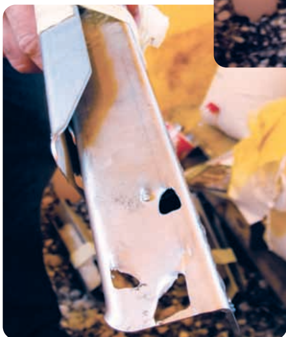
Oštećenja na lopatici rasipača
