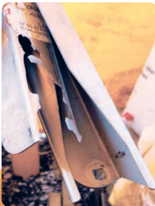
Oštećenja na lopatici rasipača
