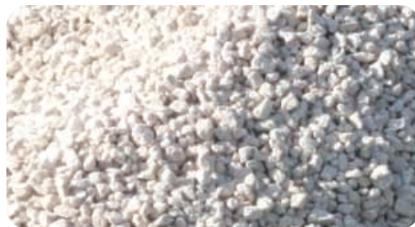
Slika 8. Kompaktno mineralno đubrivo sa uglom nasipanja do 33°
